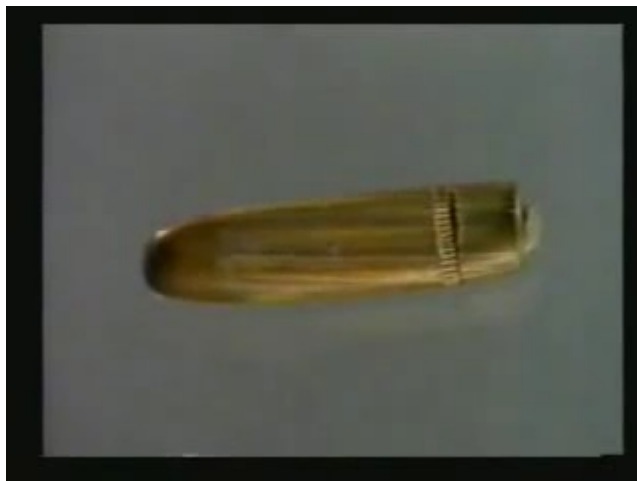
Beide kogels zijn in een bak gevuld met wol en water afgeschoten. Ze zijn onbeschadigd
